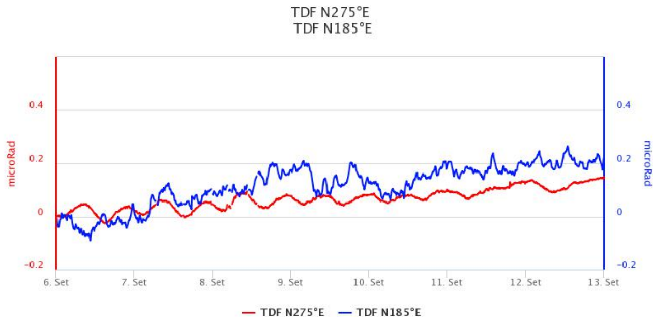
Fig. 5.2 - Serie temporale delle componenti N275E e N185E della stazione clinometrica di TDF nel corso dell'ultima settimana (microrad).
