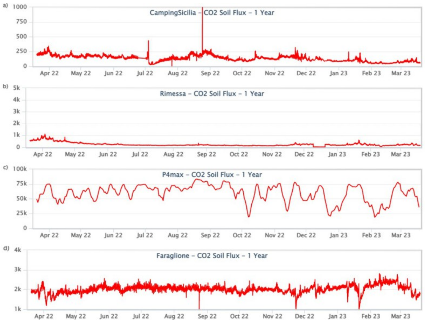
Fig. 7.1 Record temporale del flusso di CO 2 (in g/m 2 /day) emesso dai suoli registrato nei siti di C.Sicilia, Rimessa, P4max e Faraglione.
