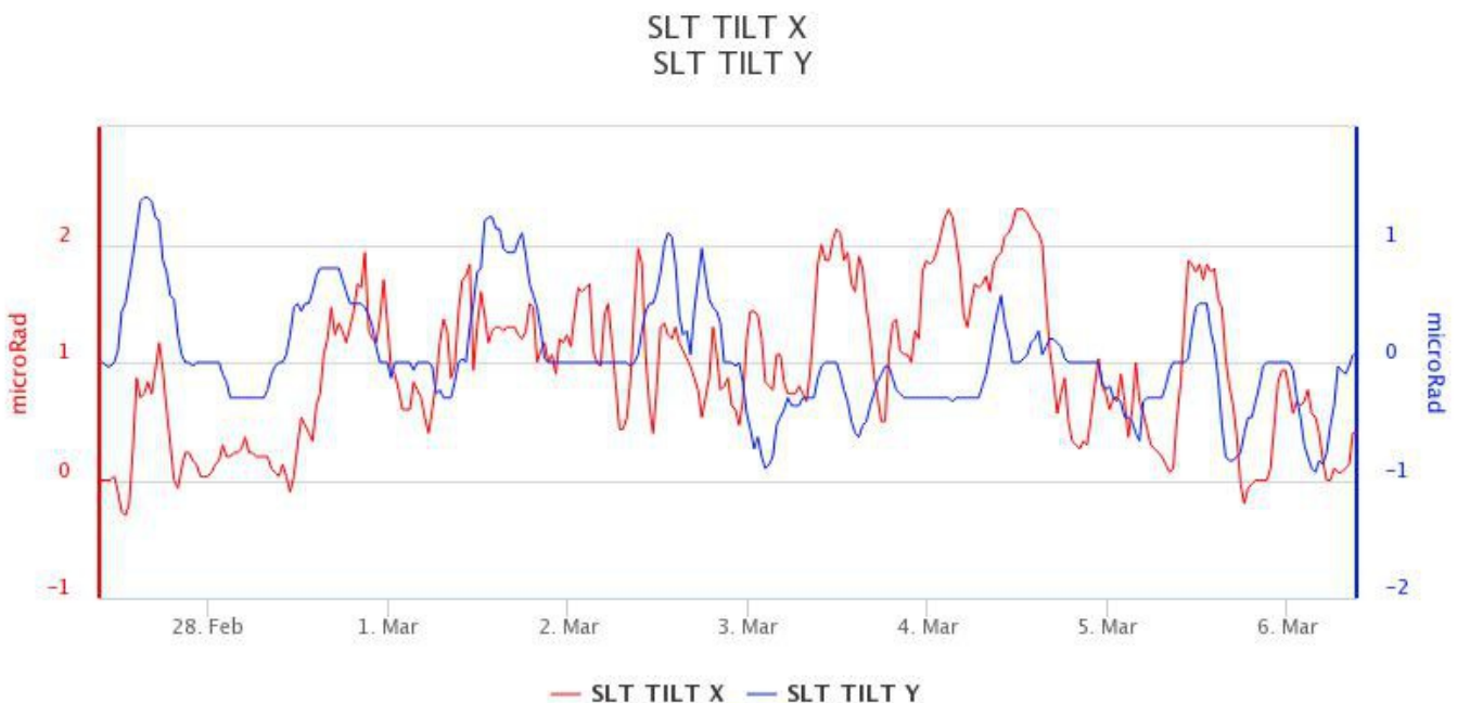
Fig. 12.1 Serie temporale delle componenti Radiale (X) e Tangenziale (Y) del clinometro di SLT dell'ultima settimana
