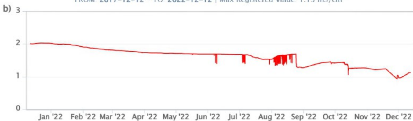
Fig. 8.2 Dati di livello e conducibilità riferita a 20°C acquisiti in automatico nel pozzo Bambara.
