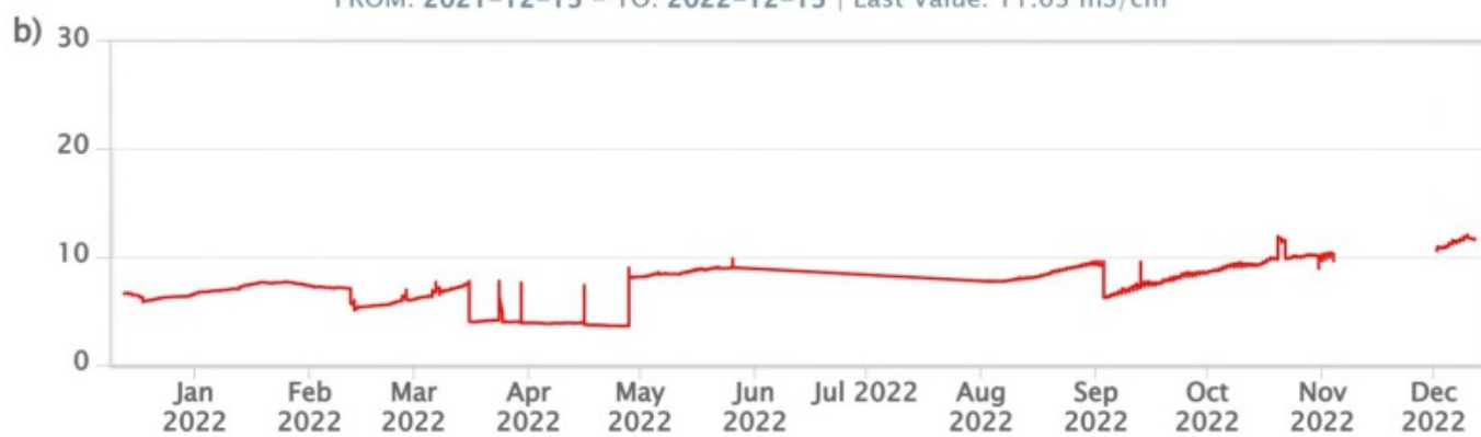
Fig. 8.1 Fig. 8.1 Dati di temperatura e conducibilità riferita a 20°C acquisiti in automatico nel pozzo C. Sicilia.
