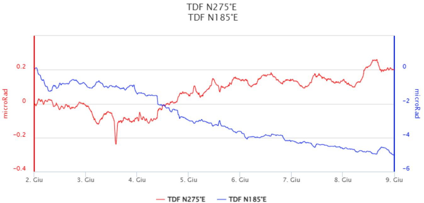
**Fig. 5.2** Componenti del segnale clinometrico della stazione di Timpone del Fuoco (TDF) nel corso dell'ultima settimana.
