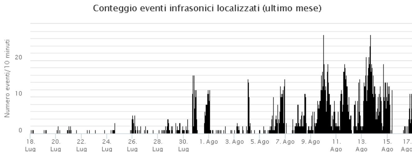
Fig. 5.1 Andamento della frequenza di accadimento degli eventi infrasonici localizzati calcolata su intervalli temporali di 10 minuti.
