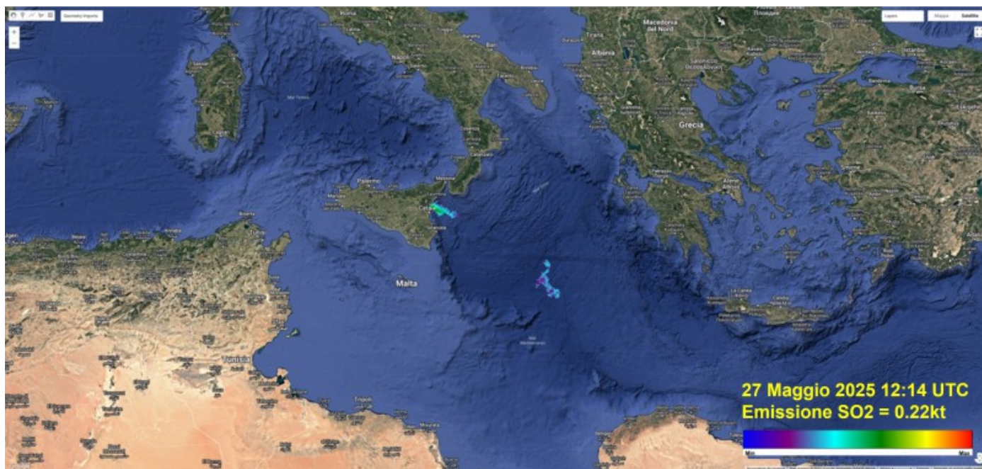
Fig. 8.2 Immagine TROPOMI ad alta risoluzione delle concentrazioni di SO2 nell'atmosfera del 27 maggio 2025 alle ore 12:14 UTC.
