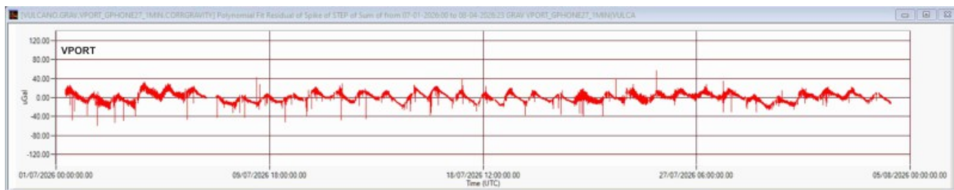
Fig. 13.1 Segnale gravimetrico registrato nella stazione VPORT dalle 00:00 UTC dell'1 luglio alle 23:00 UTC del 4 agosto 2026. Il segnale è mediato al minuto. I dati sono corretti per gli effetti della marea terrestre e della deriva strumentale.
