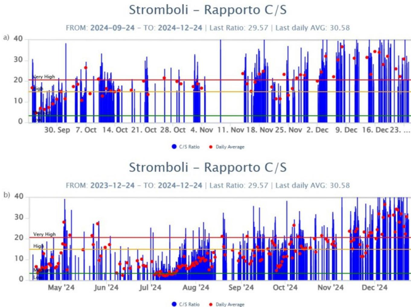
Fig. 6.3 Andamento medio settimanale del rapporto CO<sub>2</sub>/SO<sub>2</sub> nel plume: a) ultimi tre mesi; b) ultimo anno.
