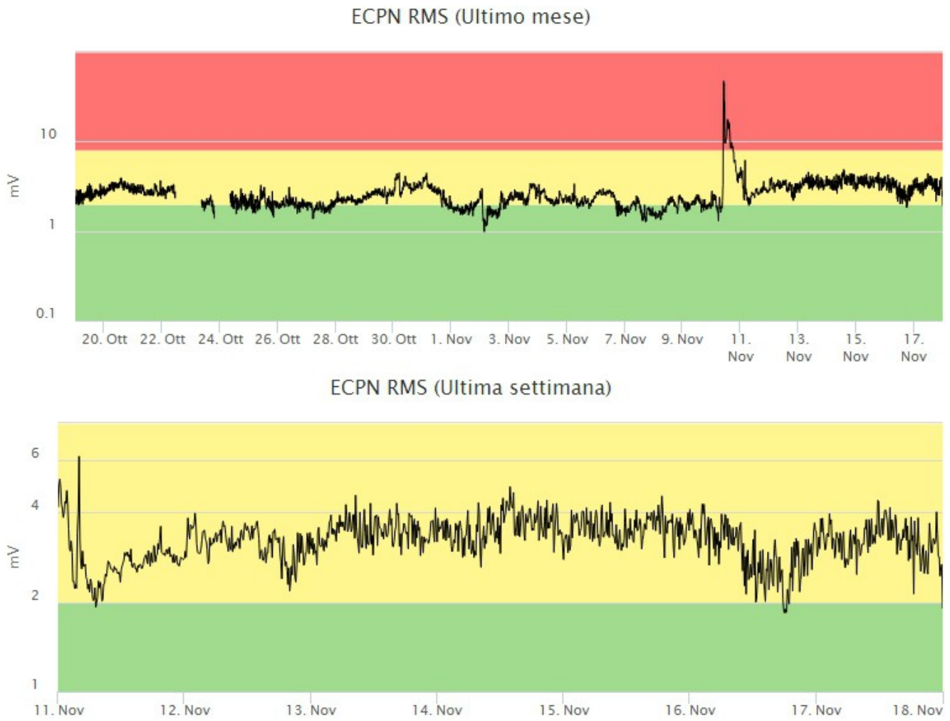
Fig. 4.2 Andamento temporale dell'ampiezza del tremore vulcanico: valori RMS nell'ultimo mese (in alto) e nell'ultima settimana (in basso) secondo tre livelli di ampiezza (basso=verde, medio=giallo, alto=rosso).
