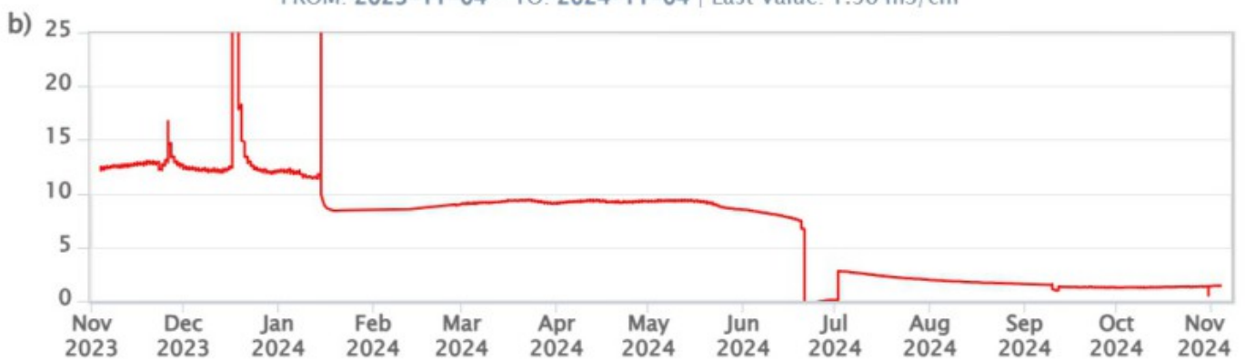
Fig. 8.1 Dati di temperatura e conducibilità a 20°C, acquisiti in continuo nel pozzo Camping Sicilia.
