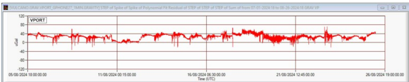
Fig. 13.1 Segnale gravimetrico registrato nella stazione VPORT dalle 18:00 UTC del 05 alle 19:00 UTC del 26 agosto 2024. Il segnale è mediato al minuto. I dati sono corretti per gli effetti della marea terrestre e della deriva strumentale.
