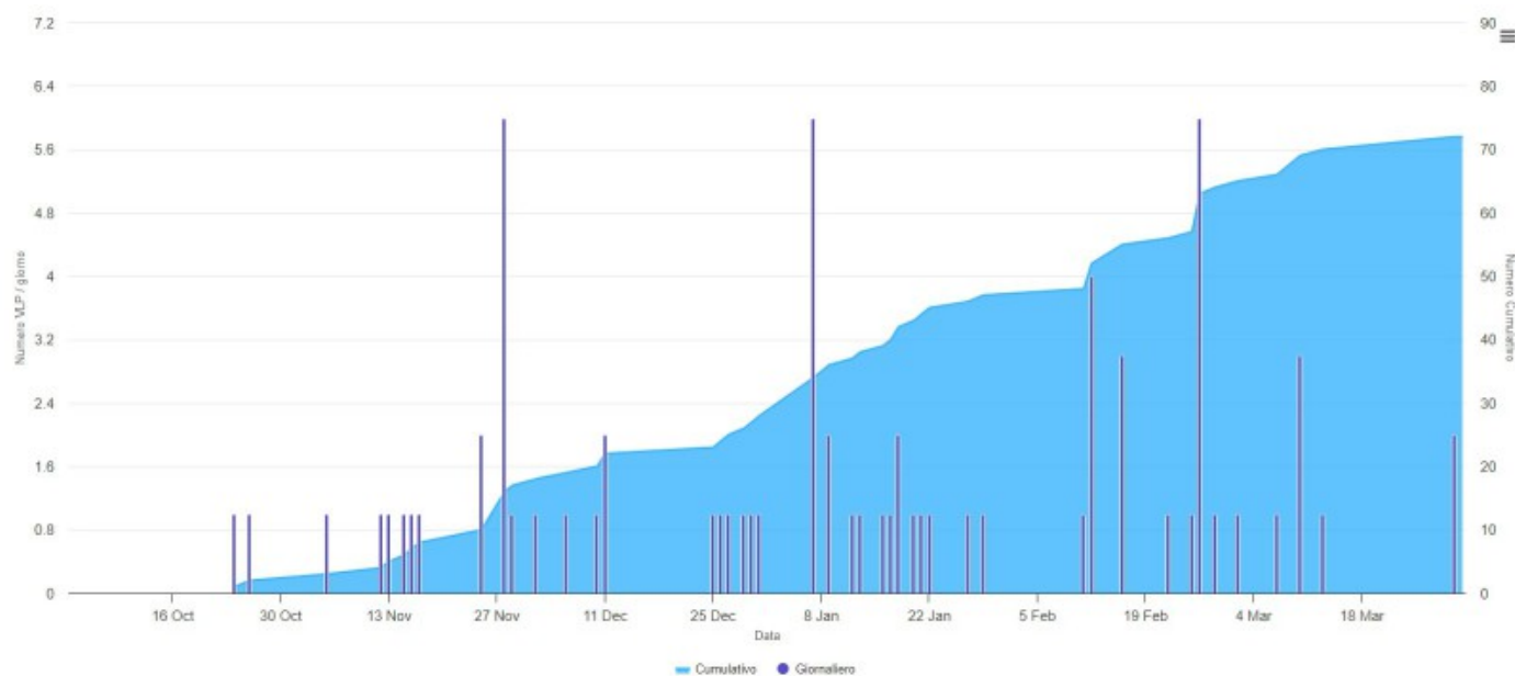
Fig. 9.2 Frequenza giornaliera e numero cumulativo delle micrososse locali con frequenza di picco minore di 1 Hz (principalmente eventi VLP), negli ultimi 180 giorni.
