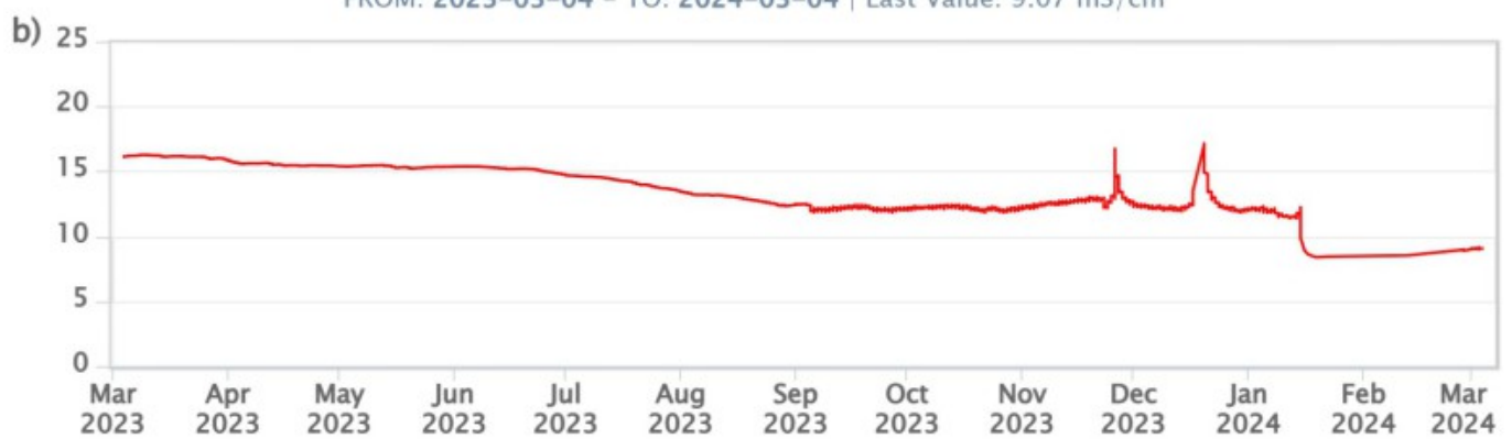
Fig. 8.1 Dati di temperatura e conducibilità riferita a 20°C, acquisiti in automatico nel pozzo C. Sicilia.
