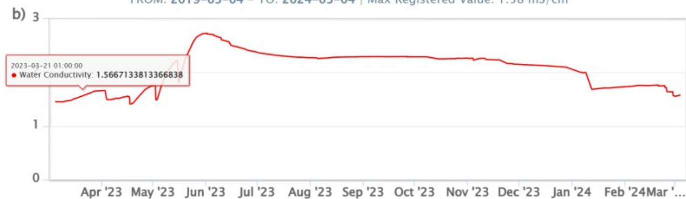
Fig. 8.2 Dati di temperatura e conducibilità riferita a 20°C, acquisiti in automatico nel pozzo Bambara.
