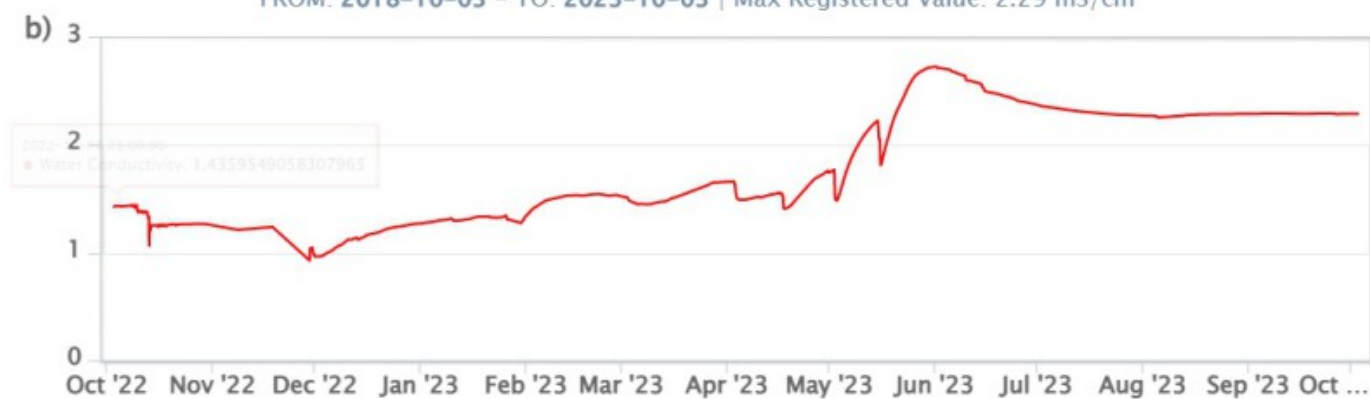
Fig. 8.2 Dati di livello freatico e di conducibilità riportata a 20°C, acquisiti in automatico nel pozzo Bambara.
