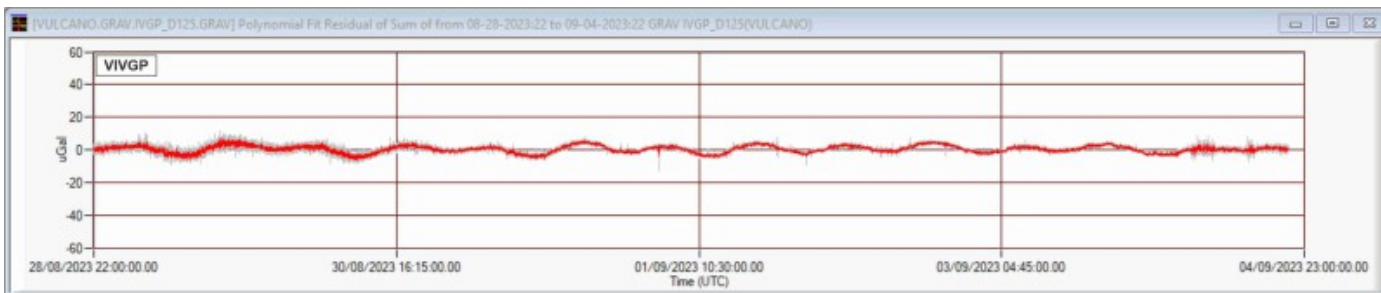
Fig. 13.1 Segnale gravimetrico registrato nella stazione VVIGP dalle 22:00 UTC del 28 agosto alle 22:00 UTC del 04 settembre 2023. In grigio segnale acquisito al secondo; in rosso il segnale mediato al minuto. I dati sono corretti per gli effetti della marea terrestre e della deriva strumentale.
