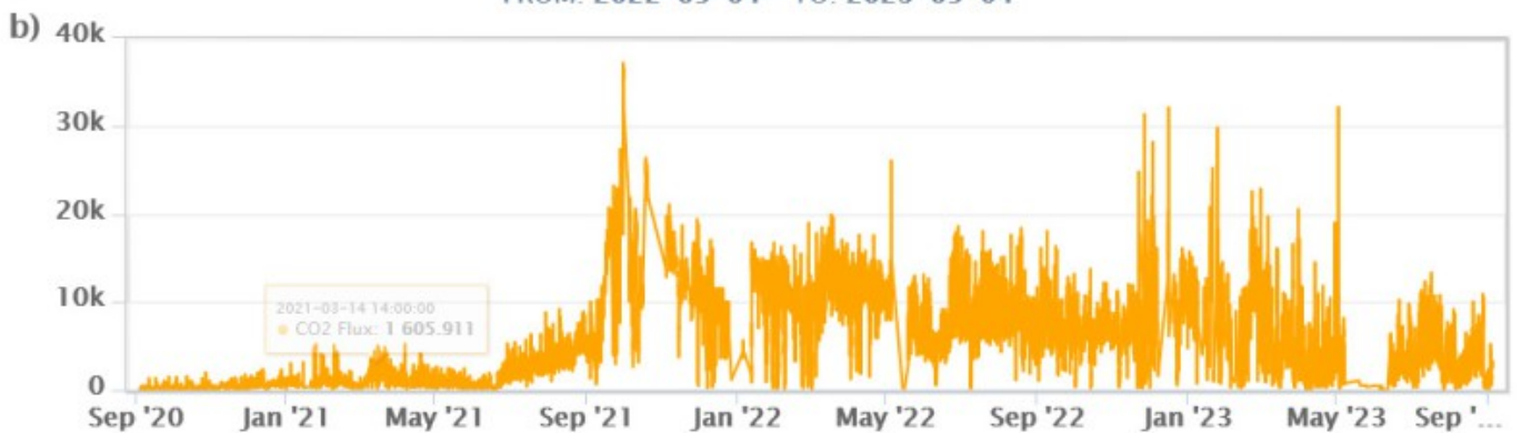
Fig. 4.1 Registrazione automatica del flusso diffuso di CO 2 dal suolo nel sito a est dell'area fumarolica (sito VCS).
