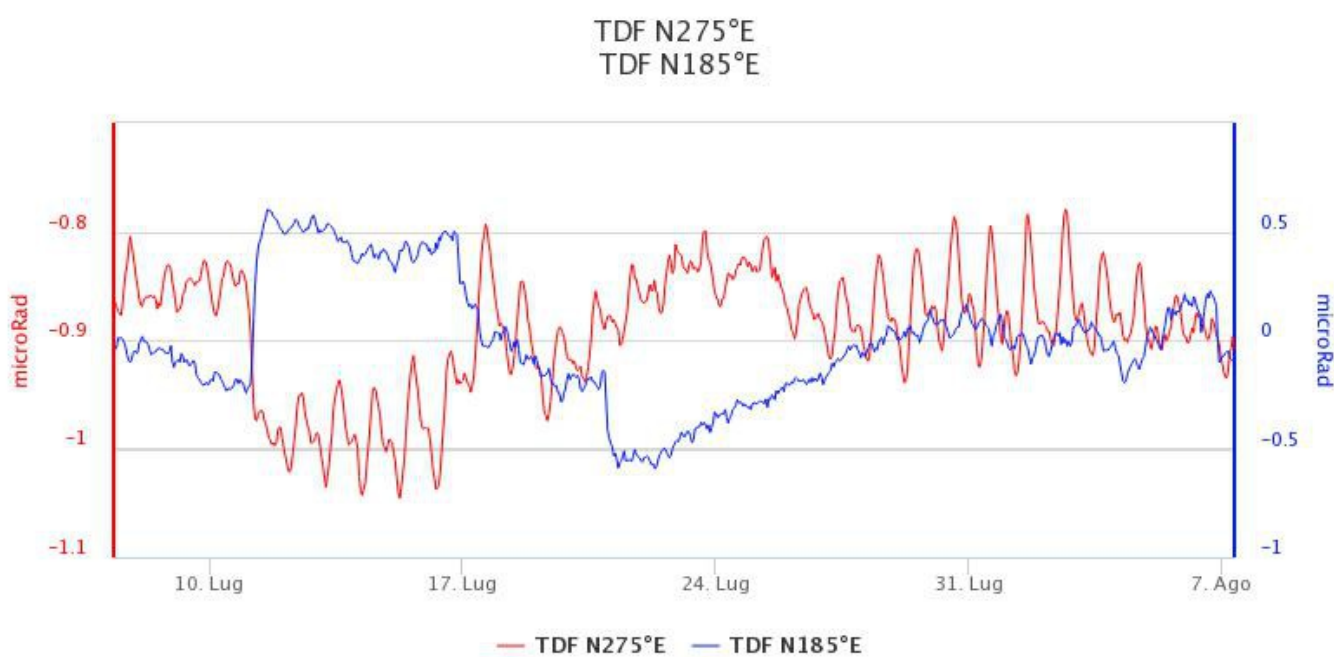
Fig. 5.1 Serie temporali delle componenti X e Y della stazione tilt di TDF
