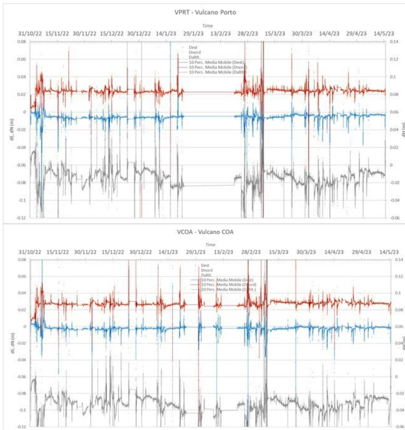
**Fig. 14.1** Spostamenti misurati alle stazioni GNSS mobili del COA e di Vulcano Porto dall'inizio del mese di novembre 2022. La linea continua rappresenta una media mobile su una finestra di 10 minuti.
