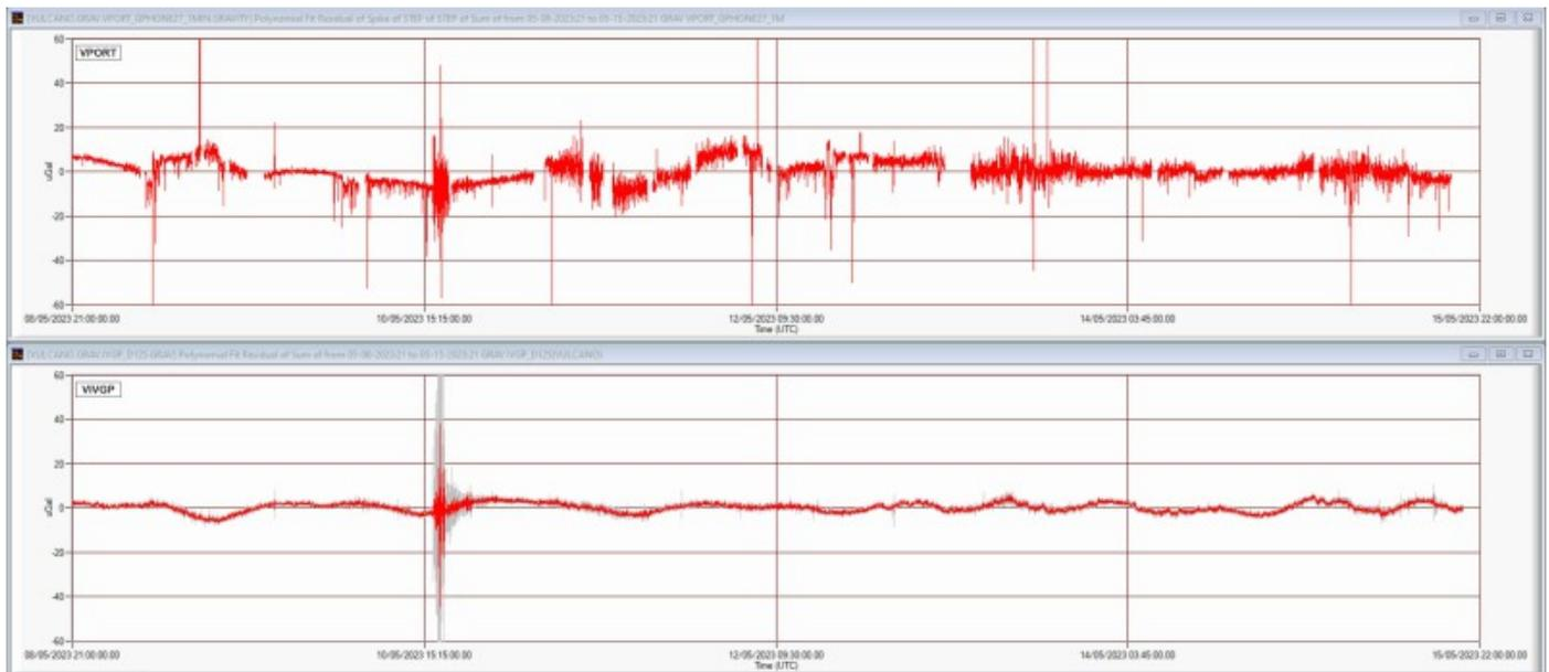
Fig. 13.1 Segnali gravimetrici registrati nelle stazioni VPORT (in alto) e VVIGP (in basso) dalle 21:00 UTC del 08 alle 21:00 UTC del 15 maggio 2023. In grigio segnali acquisiti al secondo; in rosso i segnali mediati al minuto. I dati sono corretti per gli effetti della marea terrestre e della deriva strumentale.
