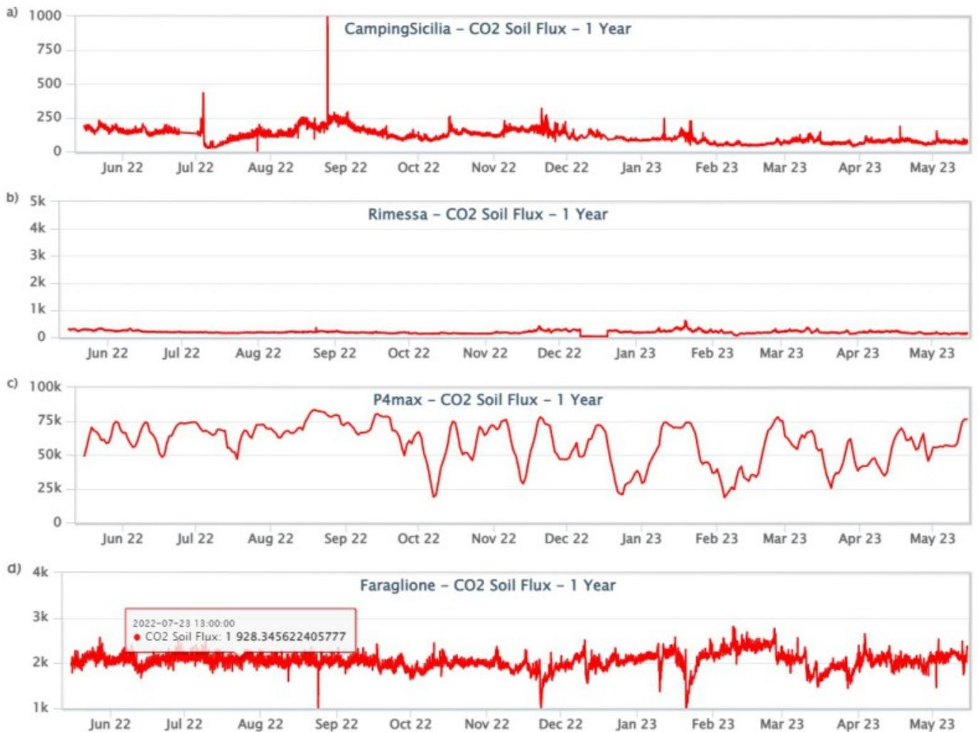
**Fig. 7.1** Record temporale del flusso di CO2 (in g/m<sup>2</sup>/day) emesso dai suoli registrato nei siti di C.Sicilia, Rimessa, P4max e Faraglione.
