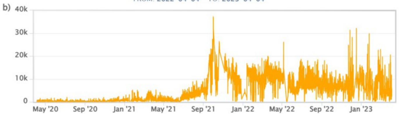
Fig. 4.1 Registrazione automatica del flusso diffuso di CO 2 dal suolo nel sito a Est dell'area fumarolica (sito VSCS).
