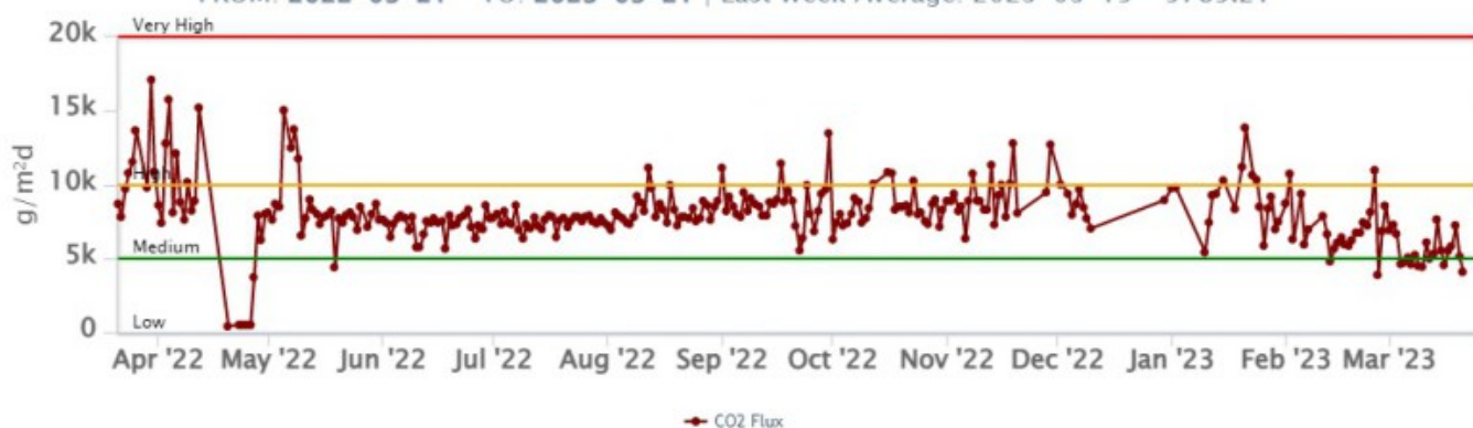
Fig. 6.2 Andamento temporale del flusso di CO 2 dal suolo: a) ultimi tre mesi; b) ultimo anno.
