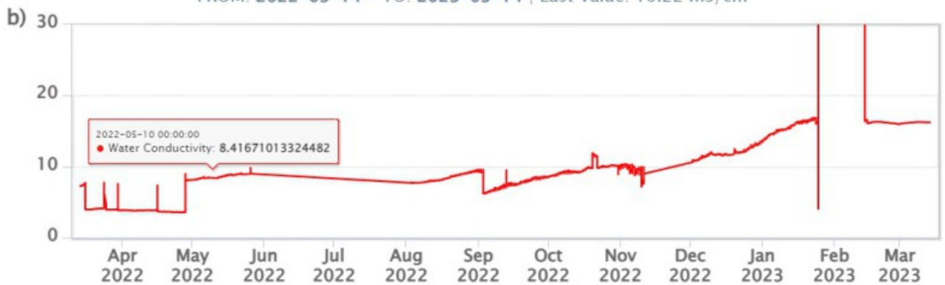
Fig. 8.1 Dati di temperatura e conducibilità riferita a 20°C acquisiti in automatico nel pozzo C. Sicilia.
