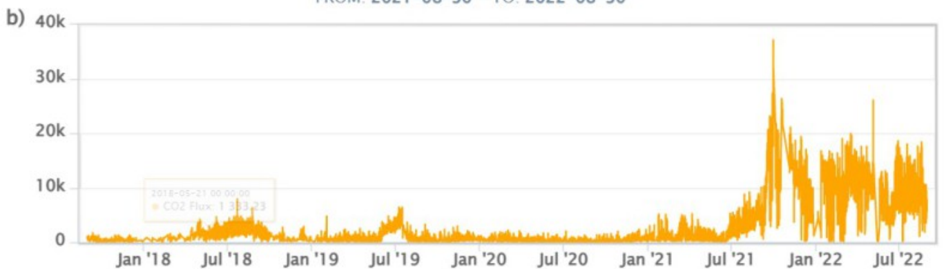
Fig. 4.1 Registrazione automatica del flusso medio diffuso di CO 2 dal suolo nel sito posto a Est dell'area fumarolica (sito VSCS). a) ultimo anno; b) ultimi 5 anni.
