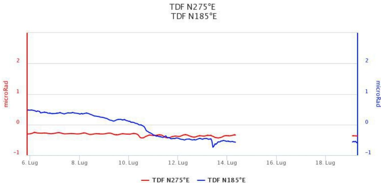
**Fig. 5.2** Serie temporale delle componenti N275°E e N185°E alla stazione clinometrica di TDF.
