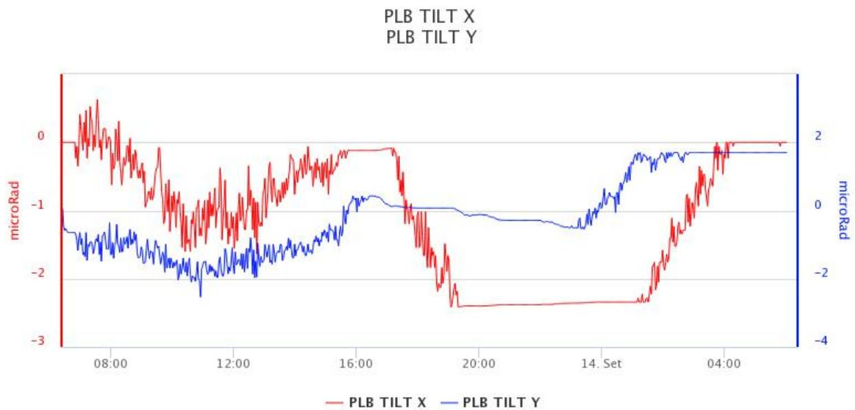
**Fig. 5.2** - componenti X e Y del segnale tilt della stazione PLB
