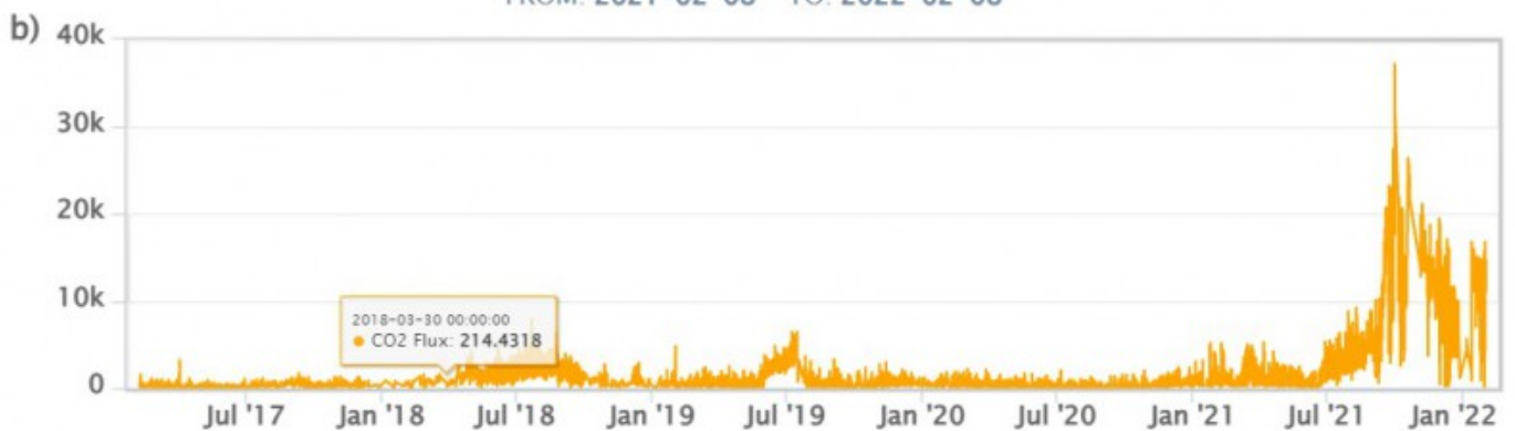
Fig. 4.1 Registrazione automatica del flusso diffuso di CO 2 dal suolo nel sito posto a Est dell'area fumarolica (sito VCS).
