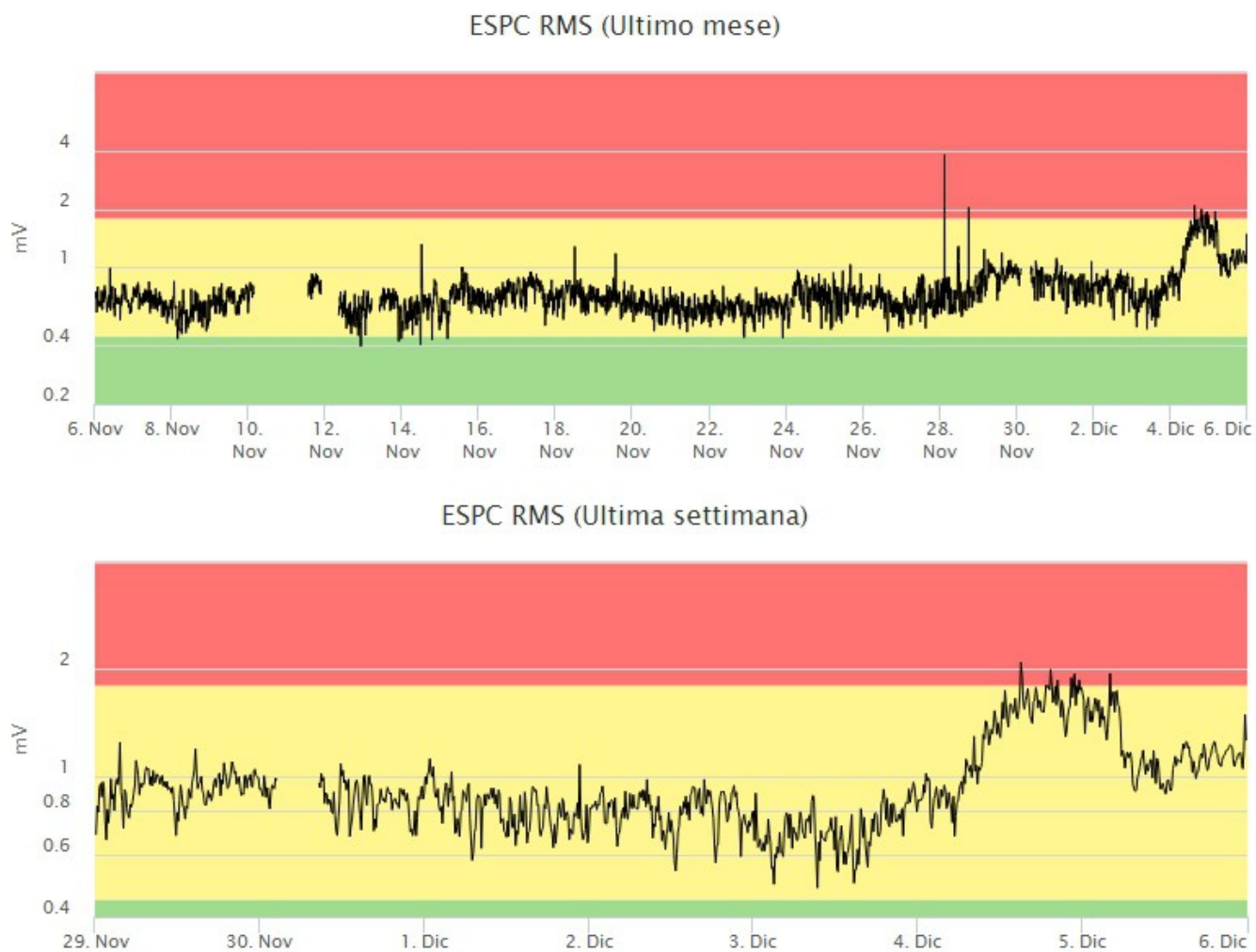
Fig. 4.3 Andamento temporale dell'ampiezza del tremore vulcanico: valori RMS nell'ultimo mese (in alto) e nell'ultima settimana (in basso) secondo tre livelli di ampiezza (basso=verde, medio=giallo, alto=rosso).
