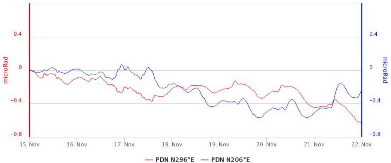
Fig. 6.3 - Serie temporale delle componenti N296E e N206E del clinometro di PDN (Pizzi Deneri), nel corso dell'ultima settimana.
