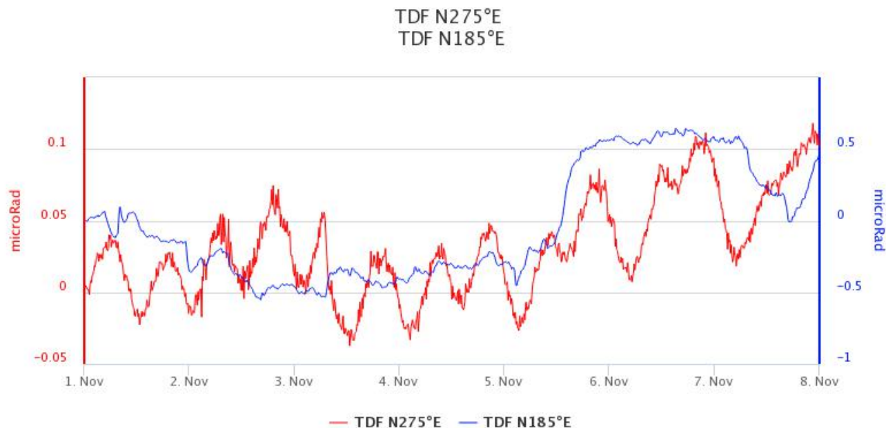
Fig. 5.2 - Serie temporale delle componenti N275E e N185E della stazione clinometrica di TDF
