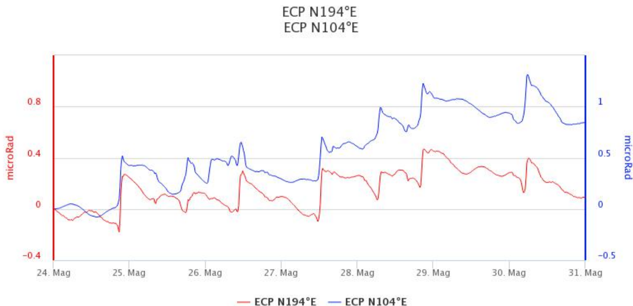
Fig. 6.3 - Dettaglio delle componenti tilt della stazione clinometrica di Cratere del Piano (ECP) durante l'ultima settimana (microradianti).
