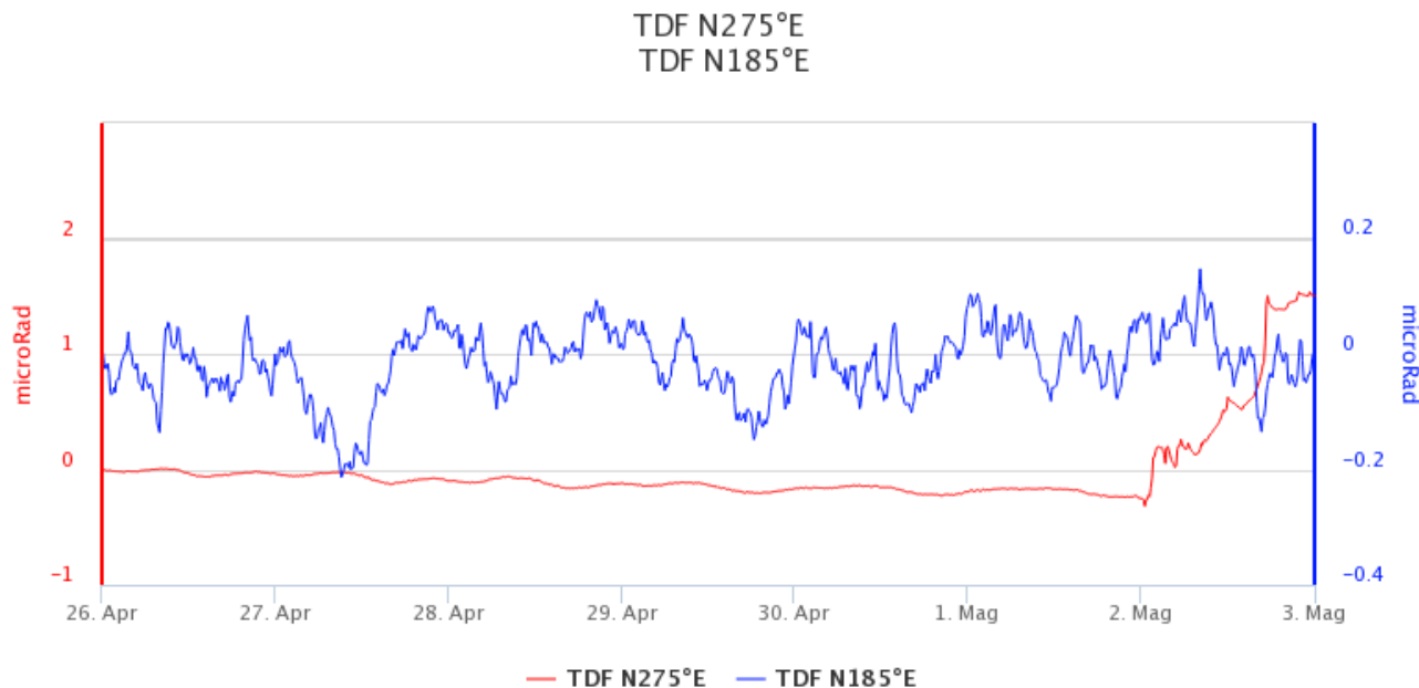
Fig. 5.2 - Serie temporale delle due componenti alla stazione clinometrica di TDF.
