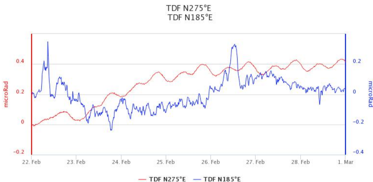
Fig. 5.2 - Serie temporale delle componenti N275E e N185E della stazione clinometrica di TDF.
