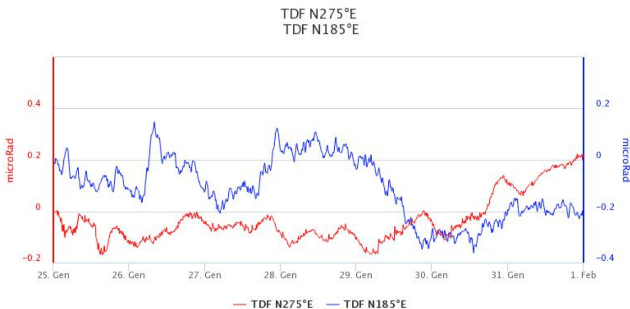
Fig. 5.2 - Serie temporali delle componenti X e Y del tilt di TDF
