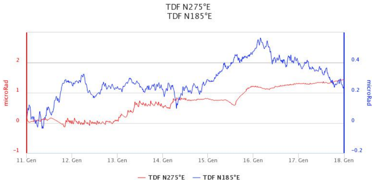
Fig. 5.2 - Componenti X e Y (microradianti) del tilt di TDF registrate nell'ultima settimana
