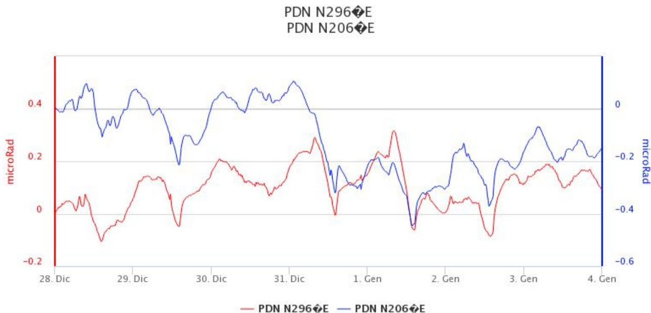
**Fig. 6.3** - Serie temporali delle componenti X e Y del tilt PDN
