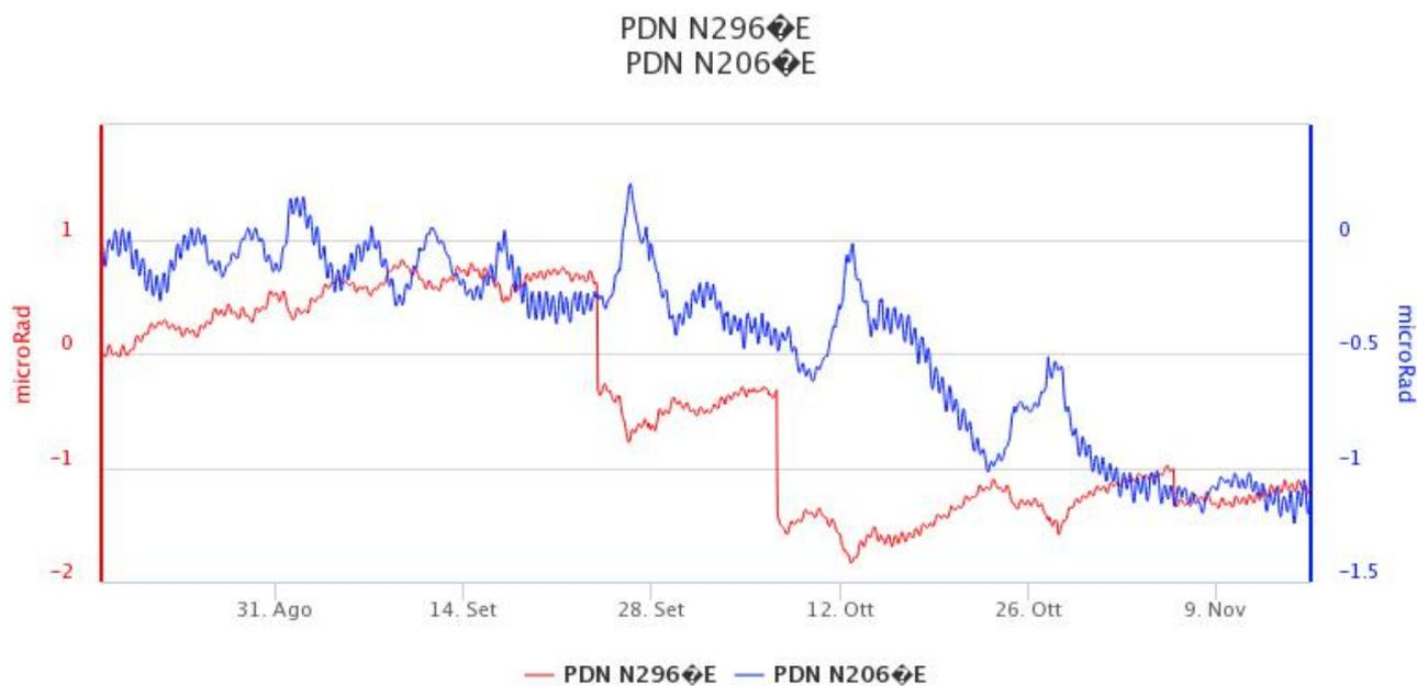
**Fig. 6.3** - Serie temporale delle componenti N296E e N206E del clinometro di PDN degli ultimi tre mesi
