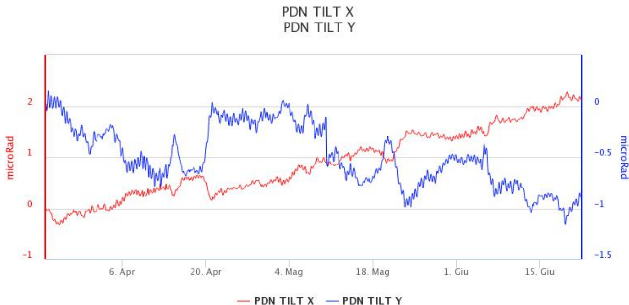
Fig. 6.3 - Serie temporale delle componenti X e Y del clinometro PDN nel corso degli ultimi tre mesi
