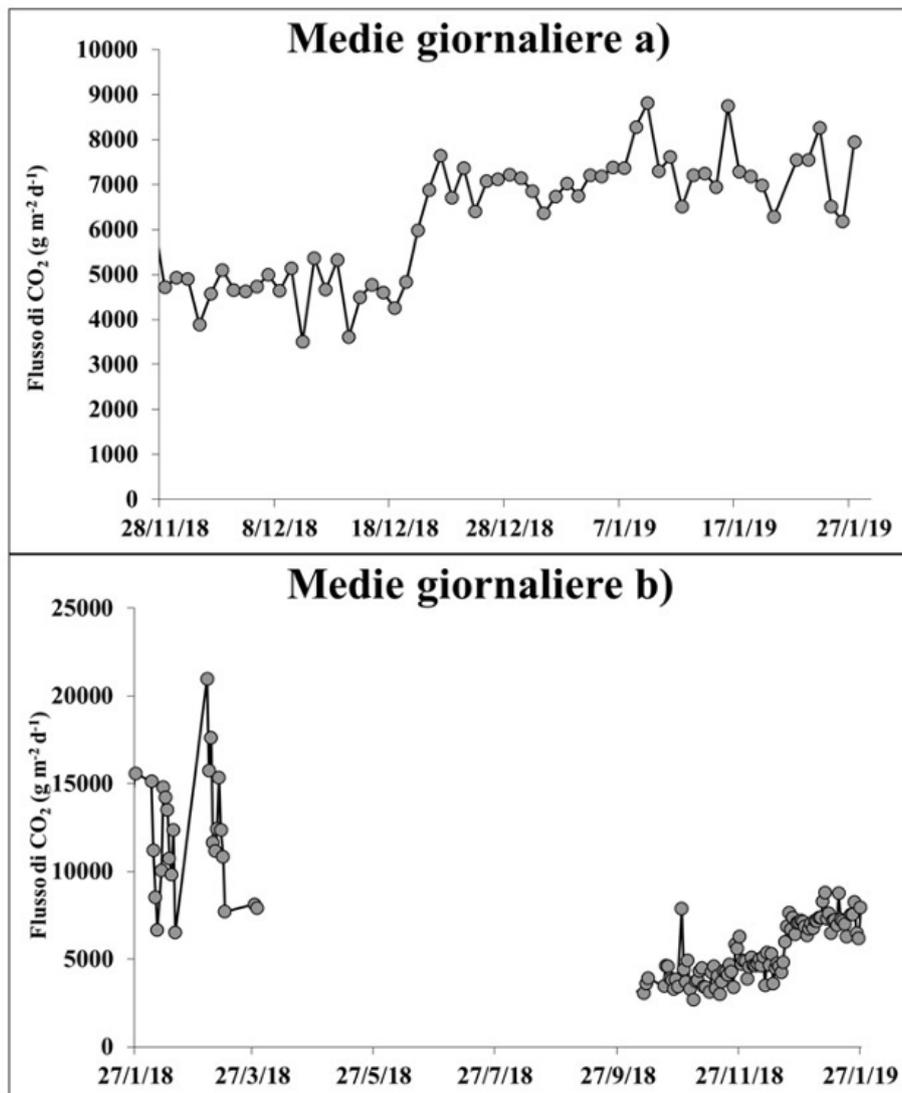
**Fig. 6.2** - Andamento temporale del flusso di CO<sub>2</sub> dai suoli: a) ultimi tre mesi; b) ultimo anno
