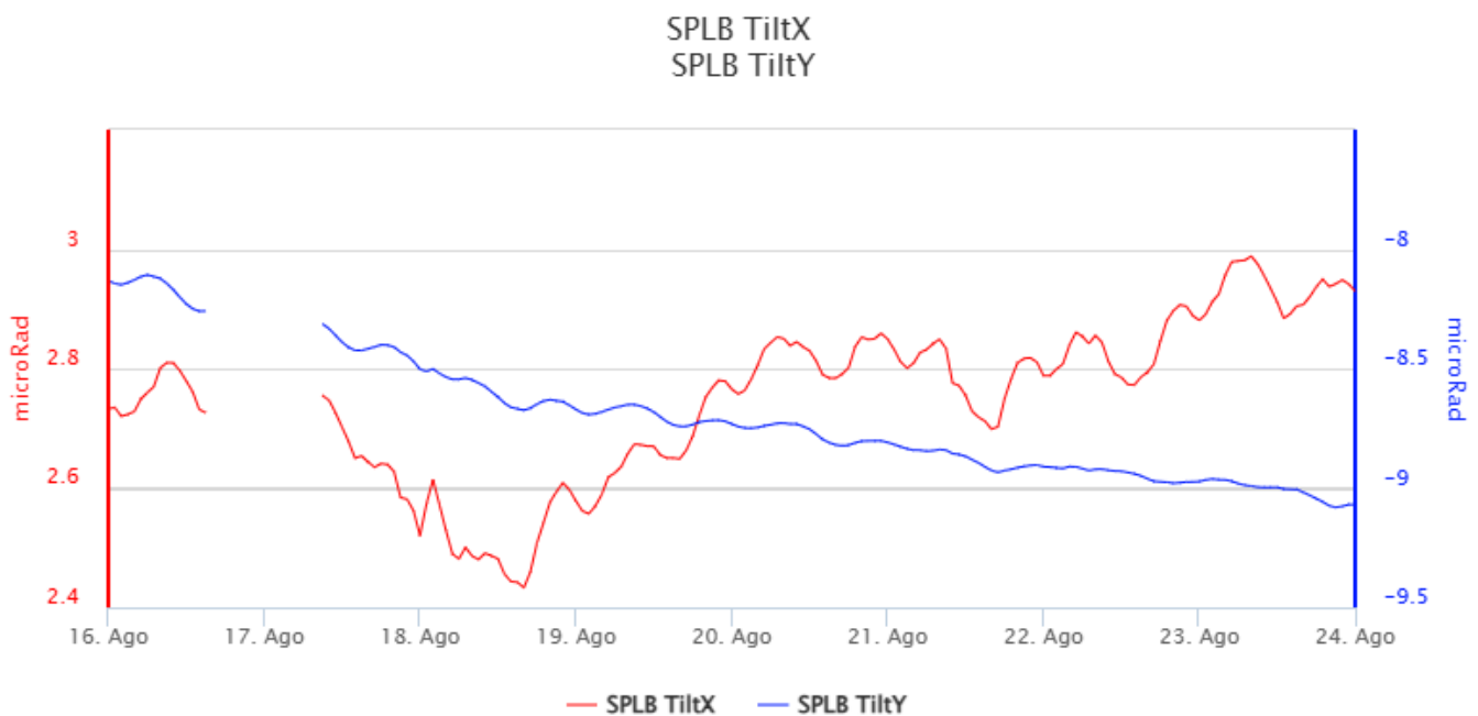
Fig. 5.2 Componenti del segnale clinometrico registrato alla stazione di Punta Labronzo (SPLB) durante l'ultima settimana
