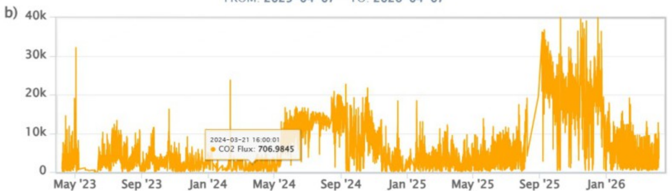
Fig. 4.1 Registrazione automatica del flusso di CO 2 emesso dal suolo nella stazione VSCS. a) Ultimo anno; b) Ultimi due anni.
