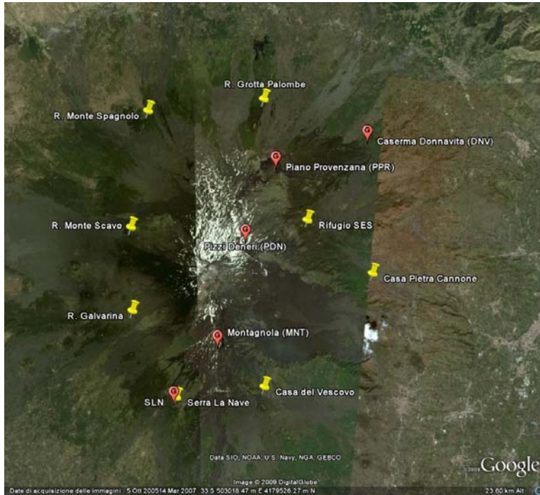
Fig. 2 – Stazioni gravimetriche per la misura assoluta dell'accelerazione di gravità. I simboli rossi indicano le stazioni occupate con il gravimetro assoluto IMGC-02 dell'INRiM; i simboli gialli indicano le stazioni misurate con il gravimetro assoluto Microg LaCoste FG5 n° 238. Nella stazione di Serra La Nave ed in quella di Catania presso l'INGV (non riportata in figura) i due gravimetri sono stati messi a confronto.
