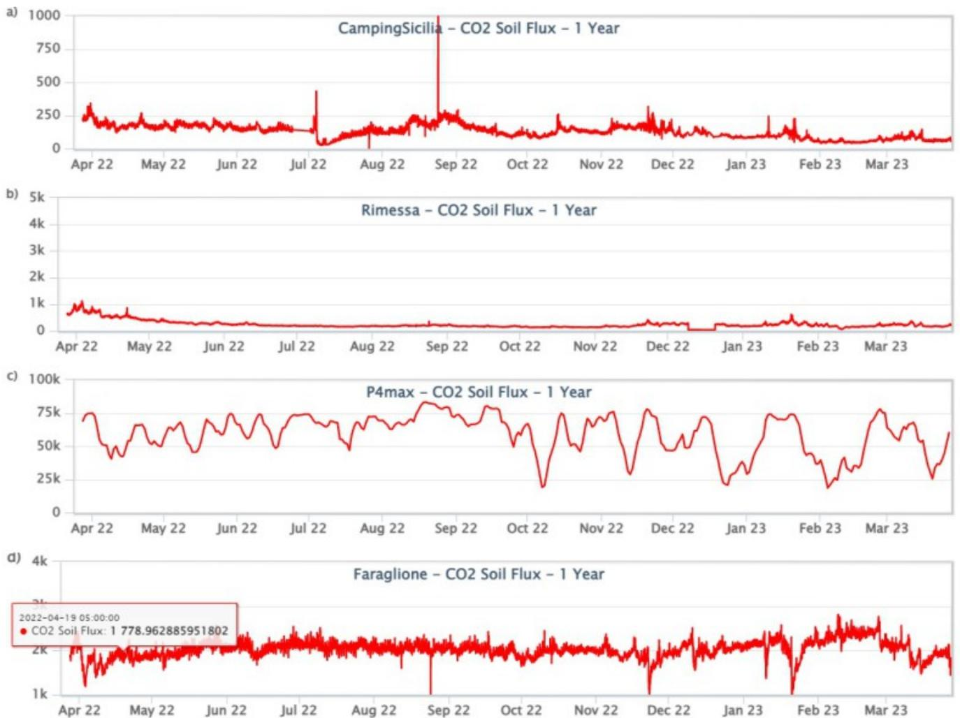
**Fig. 7.1** Record temporale del flusso di CO<sub>2</sub> (in g/m<sup>2</sup>/day) emesso dai suoli registrato nei siti di C.Sicilia, Rimessa, P4max e Faraglione.
