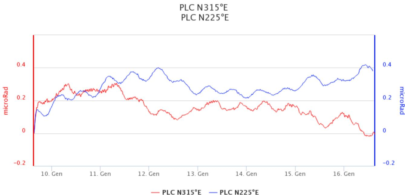
Fig. 6.3 Serie temporale delle componenti N2315E e N225E del clinometro di PLC dell'ultima settimana.
