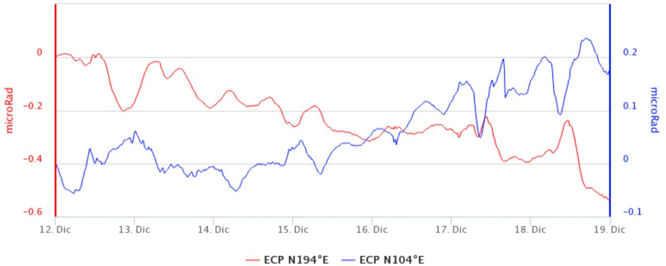
Fig. 6.3 Serie temporale delle componenti N194E e N104E del clinometro di ECP, durante l'ultima settimana.
