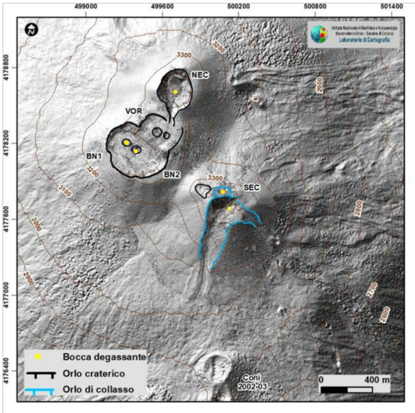
Fig. 3.1 *Modello ombreggiato del terreno dell'area sommitale dell'Etna sulla base topografica elaborata da immagini Pleiades del 22 agosto 2020 (AO Telerilevamento) con aggiornamento topografico dei crateri ottenuto da elaborazione fotogrammetrica delle immagini del sorvolo in elicottero dell'8 aprile 2022.*
