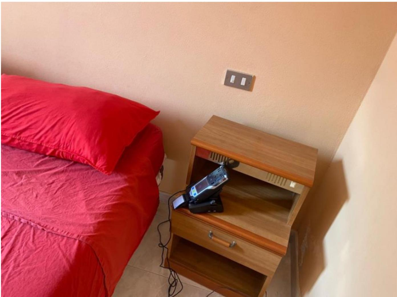
**Fig. 13.2** Ubicazione del Dispositivo Draeger XAm 800 per la misura della concentrazione di CO<sub>2</sub> in continuo in camera da letto.
