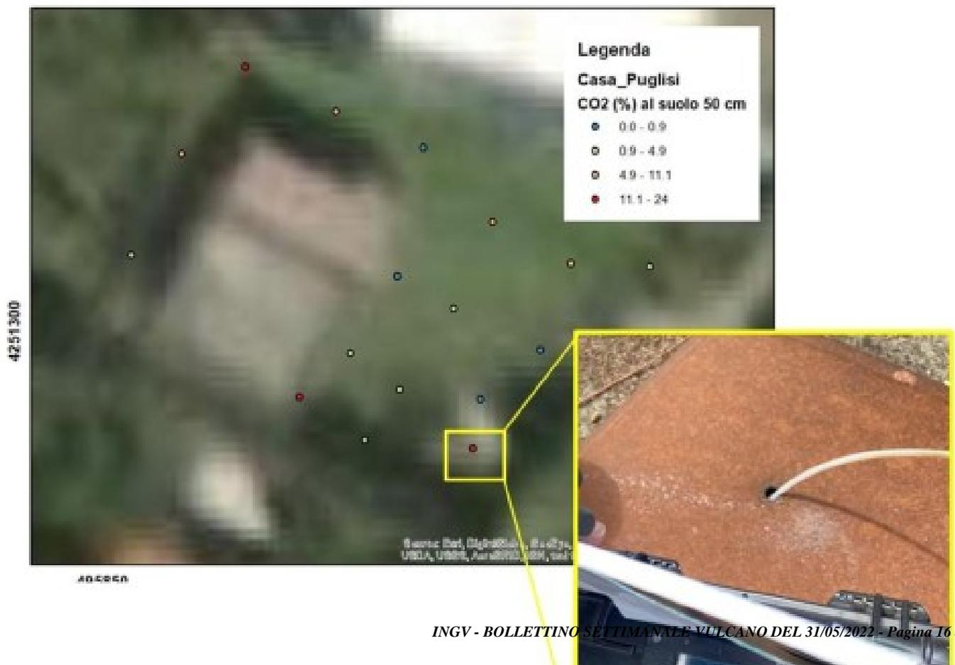
*Fig. 13.5 In alto: ubicazione dei punti di misura a 50 cm di profondità al suolo presso Casa Puglisi. Le classi di colori indicano la concentrazione al suolo di CO2 riscontrata. In basso: dettaglio dell'area investigata e, nel riquadro giallo, l'ubicazione della botola della cisterna dove è stato riscontrato fino al 17%.*
