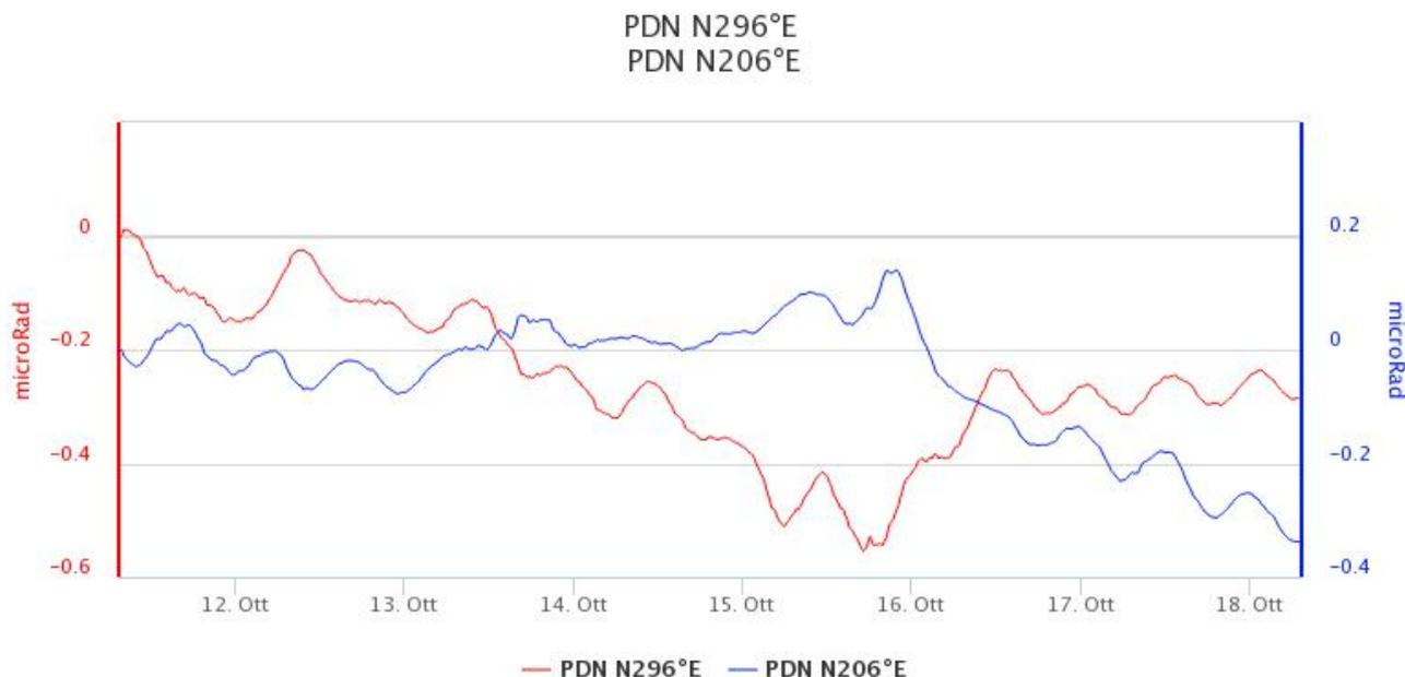
**Fig. 6.3** - Serie temporale delle componenti N2964E e N206E del clinometro di PDN dell'ultima settimana
