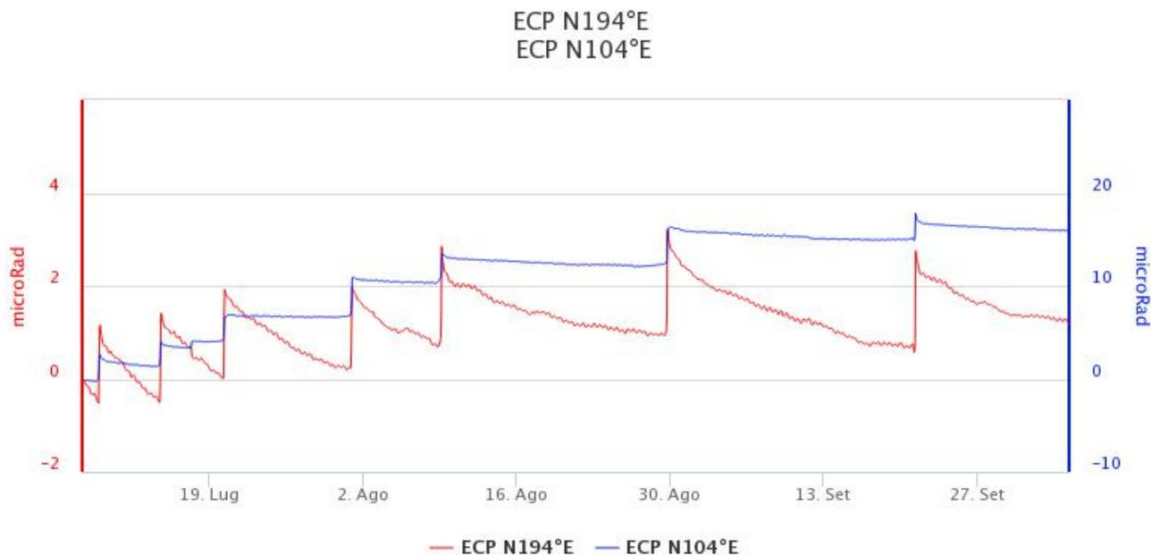
**Fig. 6.3** - Serie temporale delle componenti N194E e N104E del clinometro di ECP nel corso degli ultimi tre mesi (microrad).
