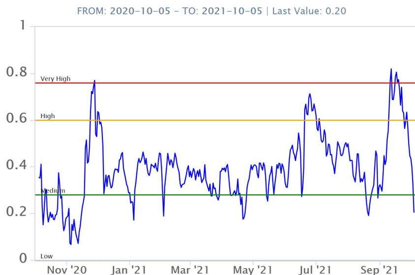
**Fig. 7.2** - Curva normalizzata dei flussi complessivi della CO<sub>2</sub> esalante dal suolo registrati dalla rete EtnaGAS nell'ultimo anno (running average su base bi-settimanale)
