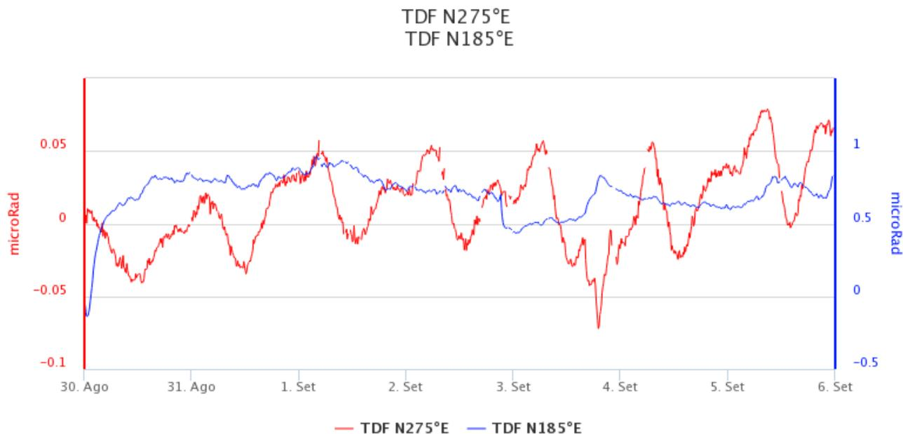
**Fig. 5.2** - Serie temporale delle componenti N275E e N185E della stazione clinometrica di TDF nel corso dell'ultima settimana (microrad).
