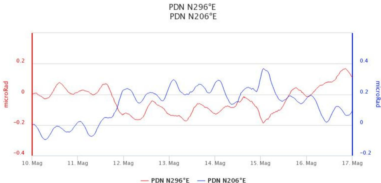
**Fig. 6.3** - Componenti del tilt alla stazione clinometrica di Pizzi Deneri (PDN).
