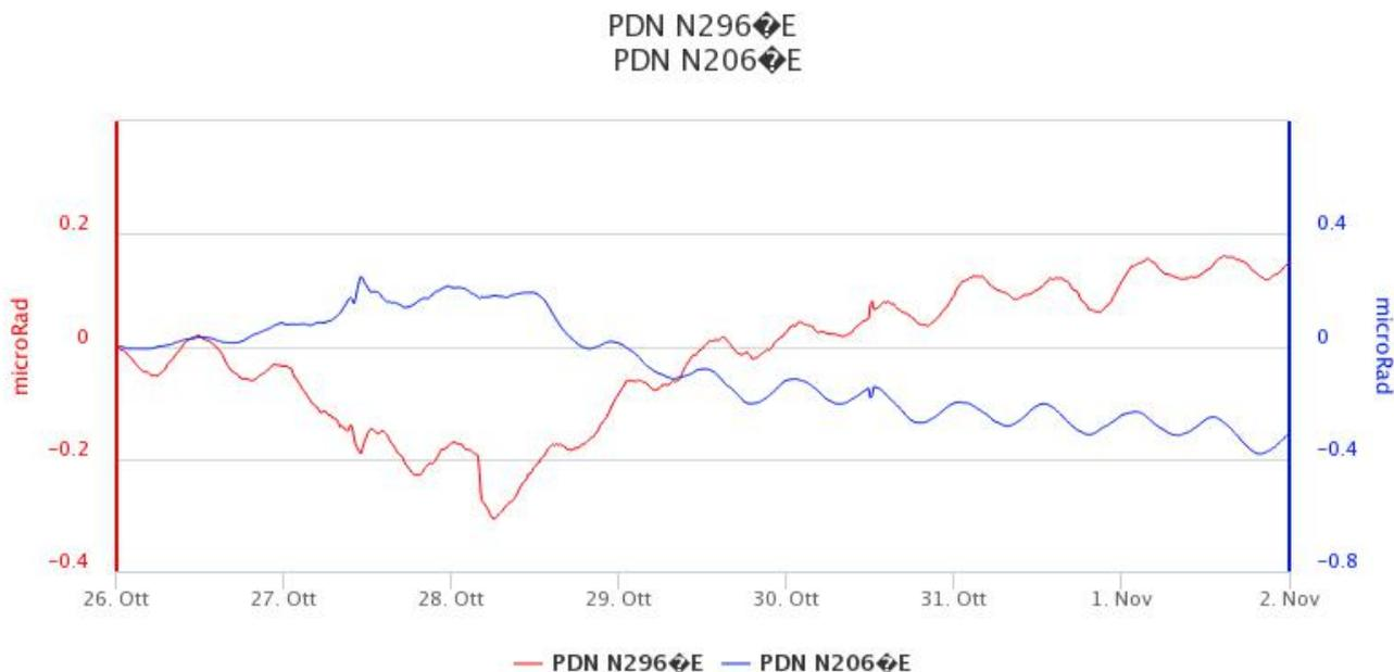
**Fig. 6.3** - Serie temporale delle componenti X e Y del clinometro PDN durante l'ultimo mese.
